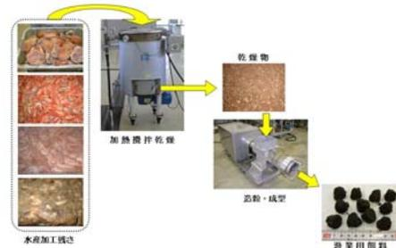
図4 ベニズワイかに籠漁業用餌料の製造方法
